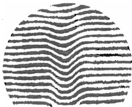
Рис. 2. Типичная интерферограмма компрессионного потока КСПУ.
