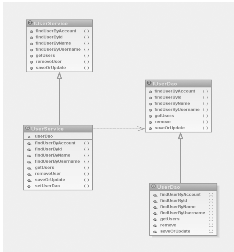
Slika D.1.1 Dijagram klase koje učestvuju u implementaciji servisa za upravljanje klijentima banke– IUserService je interfejs koji definiše operacije koje korisnik aplikacije može izvršiti nad klijentom banke ( User ), UserService je konkretna implementacija tog interfejsa, IUserDao definiše operacije nad domneskim objektom i UserDao je JPA/Hibernate implementacija tog interfejsa.
