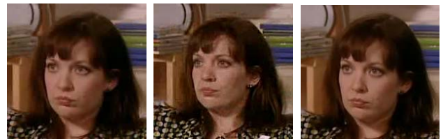
SI. 2. Slike izvađene iz video zapisa MPEG-2, MPEG-4 and H.264, respektivno, pri 1024kbps
