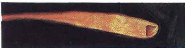
Sl. 37. Komandna kabina ulazi u atmosferu Zemlje pri čemu toplotni štiti absorbuje intenzivnu toplotu.
