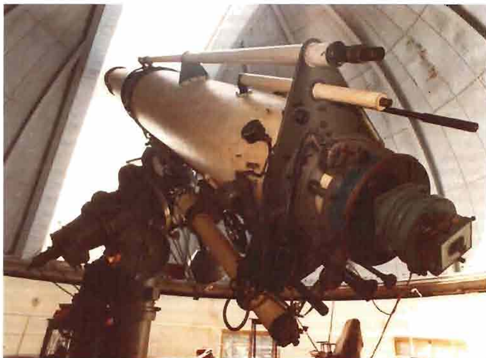
Большой рефрактор "ZEISS" 650/10550 мм экваториальный
