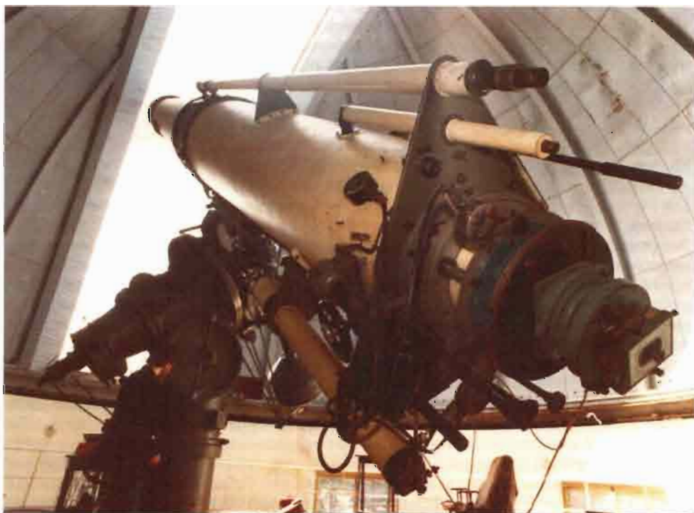
Большой рефрактор "ZEISS" 650/10550 мм экваториальный
