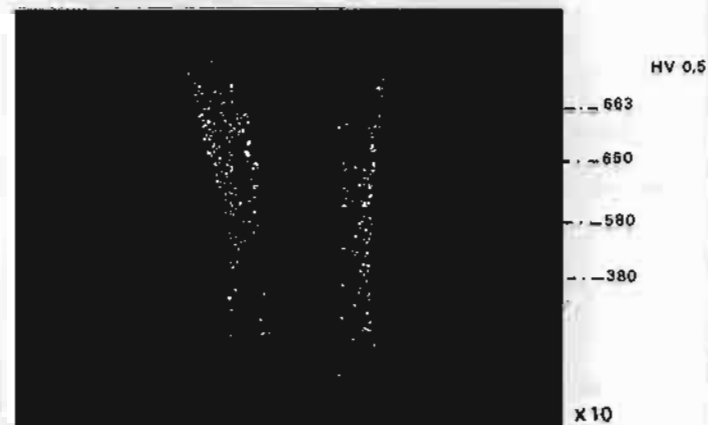
Fig. 63 - Sezione macrografica di un giunto saldato di acciaio C45, bonificato, con HRC 35, eseguito a 9 KW - Vel. 2 m/m'.
