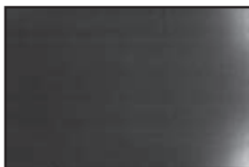
Слика 40. Цео dark frame снимак дигиталног фотоапарата Canon EOS300D обрађен тако да се истакне електролуминесценција
