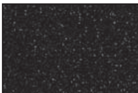
Слика 39. Исецак dark frame-а дигиталног фотоапарата Canon EOS300D, обрађен тако да се истакне thermal current ефекат
